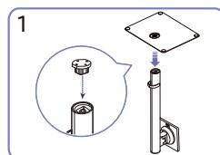
Вставьте подставку в соединительный элемент в направлении, указанном на рисунке. Убедитесь, что соединительный элемент надежно закреплен во избежание травмирования вследствие падения подставки.
