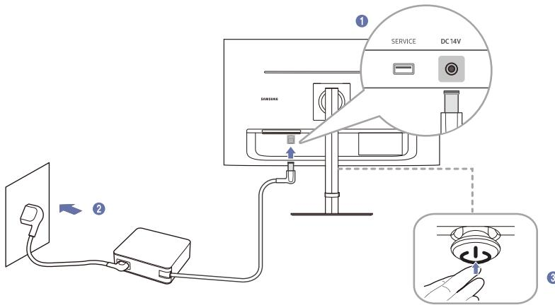
1 Подключите кабель питания к адаптеру постоянного/переменного тока. Затем подключите адаптер постоянного/переменного тока к порту постоянного тока DC14V на задней панели устройства.
