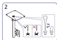
Полностью закрутите соединительный винт в нижней части подставки, чтобы как следует зафиксировать соединительный элемент. Затяните большой винт в центральной части для завершения сборки.
