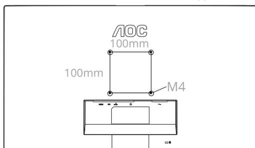
Характеристика винтов для настенного крепления: M4\* (10 + X) мм (X = толщина кронштейна для настенного монтажа)
