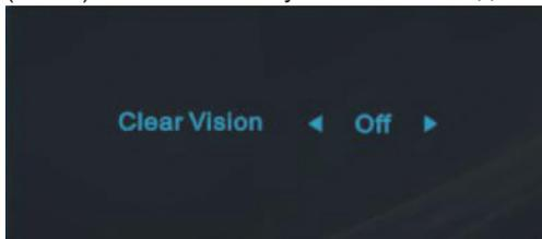
3. Нажмите и удерживайте кнопку « < » в течение 5 секунд для включения функции Clear Vision Demo (Просмотр настройки четкого вида), а на экране на 5 секунд появится сообщение «Clear Vision Demo: on» (Просмотр настройки четкого вида: вкл.). Нажмите кнопку Menu (Меню) или Exit (Выход) для сброса сообщения. Снова нажмите и удерживайте кнопку « < » в течение 5 секунд, функция Clear Vision Demo (Просмотр настройки четкого вида) отключится.
