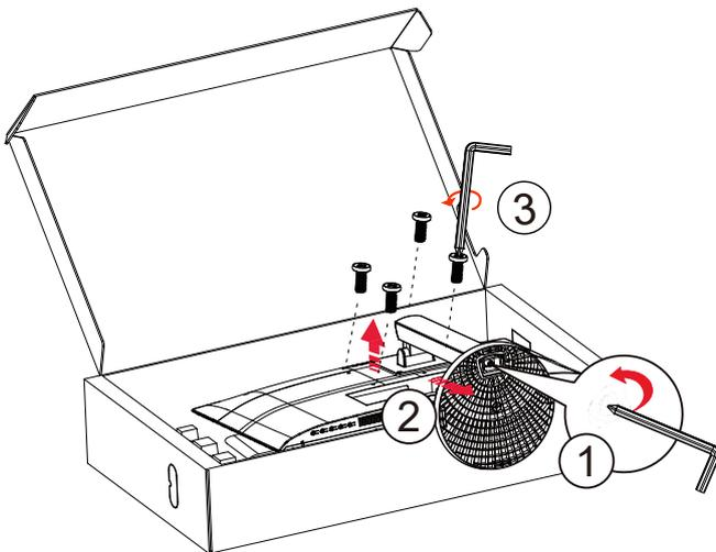
Технические характеристики для винтов основания: М6\*13 мм (эффективная длина резьбы 5,5 мм)
