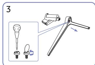
Извлеките соединительный элемент из подставки, потянув его в направлении стрелки, как показано на рисунке.
