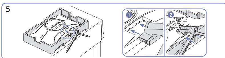
Поместите подставку в соединительный элемент, как показано на рисунке. Проверьте, надежно ли закреплен соединительный элемент подставки.
