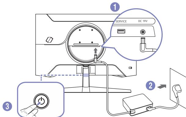
1 Подключите кабель питания к адаптеру постоянного/переменного тока. Затем подключите адаптер постоянного/переменного тока к порту постоянного тока DC19V на задней панели устройства.
