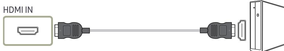
— Рекомендуется использовать кабель HDMI, входящий в комплект поставки. Если его нет в комплекте поставки, используйте разрешенный кабель для кабельных подключений через порт HDMI. При использовании неразрешенного кабеля HDMI качество изображения может ухудшиться.
