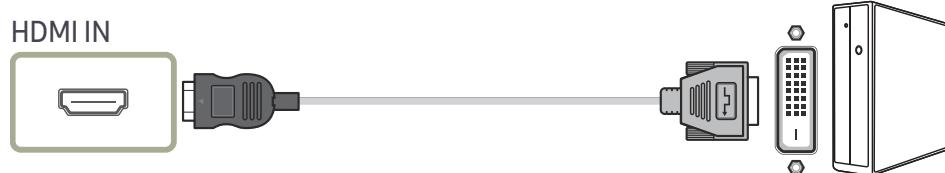
— Функция воспроизведения звука не поддерживается, если устройство подключается с помощью кабеля HDMI-DVI.
