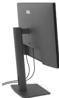
Рисунок 53. Убедитесь, что вы оставили достаточную длину кабеля для перемещения монитора
