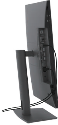
Рисунок 52. Подключите кабели в самом верхнем и максимально повернутом в сторону положении.
