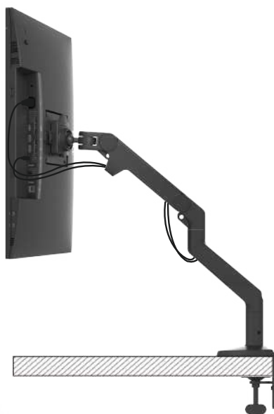
Рисунок 57. Подключите кабели в самом верхнем и максимально повернутом в сторону положении.
