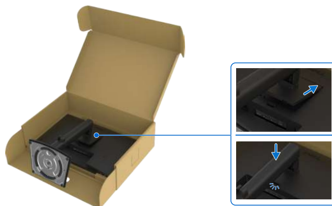
Рисунок 19. Вставьте выступы на стойке подставки в гнезда
